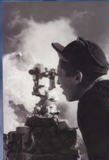
Oben: Schon 1926 wird auch in den Anden mit dem Wild T2 gemessen.
