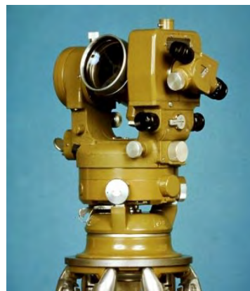
Wilds Doppel-Kreis-Theodolit mit Mikrometer Kern DKM3 (1939). Genauigkeit 0.1 sec.
